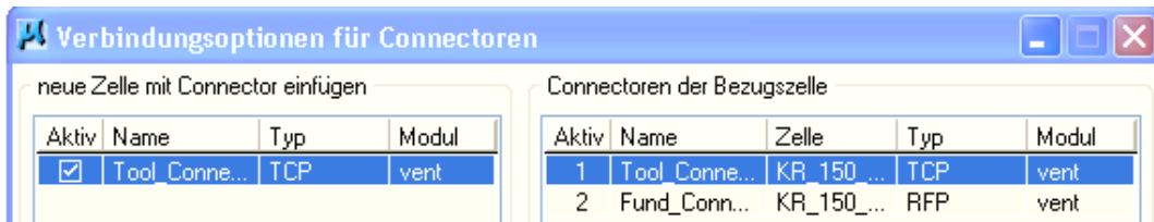
Abb. 3 TRICAD BMW Zellmanager – Objekte vom gleichen Typ (TCP) verbinden Fig. 3 TRICAD BMW cellmanager – “Same connector type only” option (here connect TCP)
