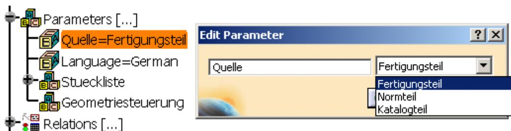
Abbildung 2-2 Parameter Quelle im Startmodell für Parts
