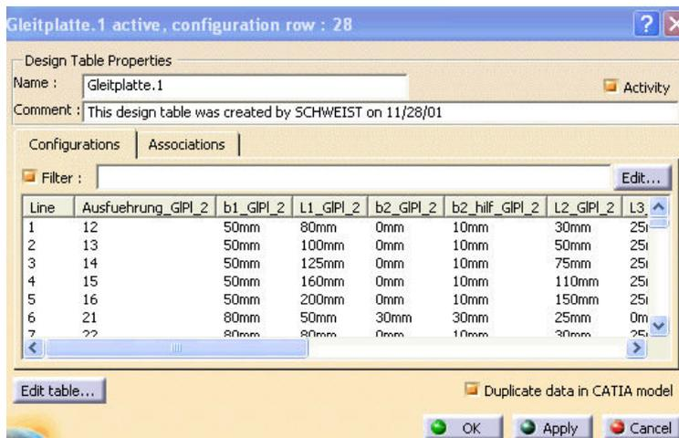
Abbildung 29 - Definition einer Konstruktionstabelle
