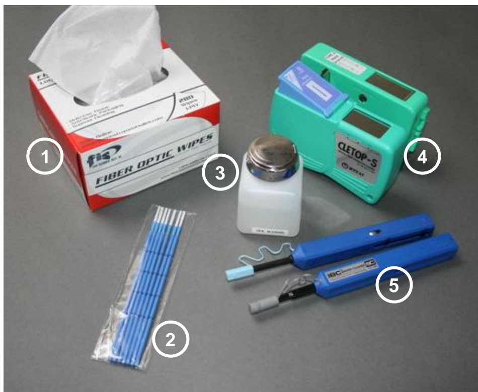
Abbildung 5: Zulässige Utensilien zur Reinigung von optischen Steckerstirnflächen (Auswahl)
