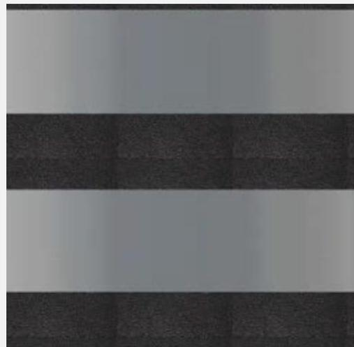
z.B. Streifenfolie (fotografiert auf schwarzem Grund) mit Balkenstärke 36 mm und Zwischenraum 26 mm
